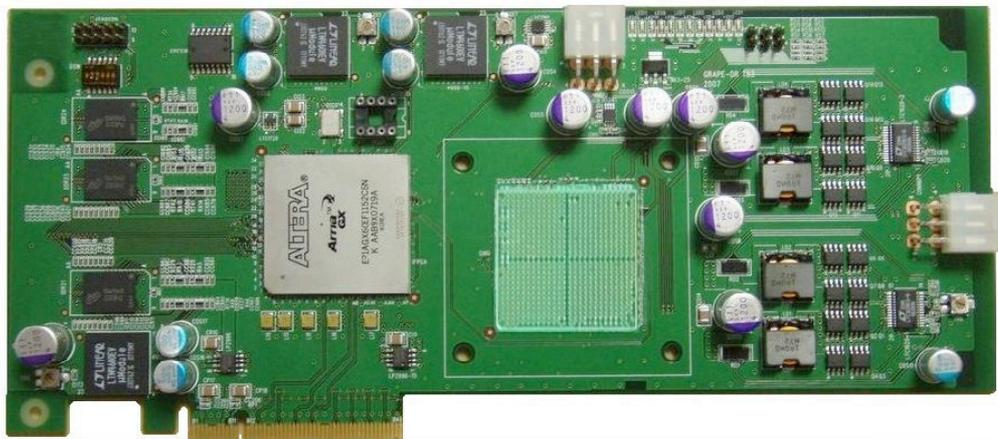
当社独自開発の PCI Express IP コア GPCle により、アルテラ社ミッドレンジ FPGA デバイス ArriaGX を用いた低コストの x8 レーンインタフェースを実現。
