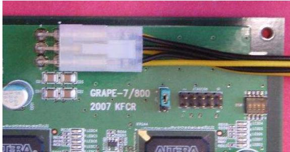
図 9: 電源ケーブルの接続 (Model 800)。
