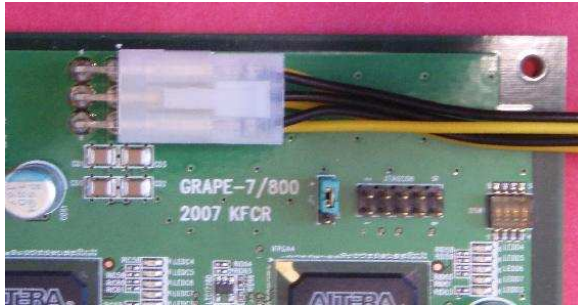
図 9: 電源ケーブルの接続 (Model 800)。
